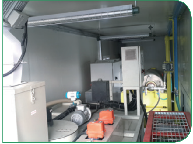
配备加药絮凝离心机处理的盾构工程泥浆净化系统
