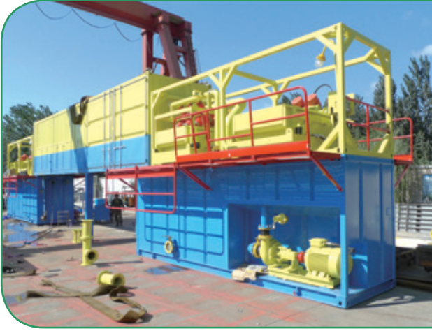
配备加药絮凝离心机处理的盾构工程泥浆净化系统
